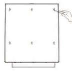
3 При помощи электродрели просверлите отверстия
